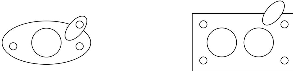
**PARA AMBOS CARBURADORES: NO SE PERMITE EL CAMBIO DE EL O LOS VENTURI AXILIARES “ AVIONCITOS”, POR OTROS DE DISTINTOS MODELOS. LIBRE PULIDO DE ESTA/S PIEZAS.-**
